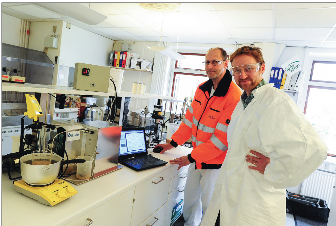
Opfinderen af RheoStream, Fridolin Okkels (th), tester her flowcellen i en opstilling hos CP Kelco sammen med Jack Hansen. Flowcellen og det øvrige målesystem er inden i aluboksen. (Foto: Michael B. Boesen).
